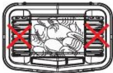
左図が示す × 印がついているヒーター部分には絶対に水は掛けないで下さい、故障の原因になります。
