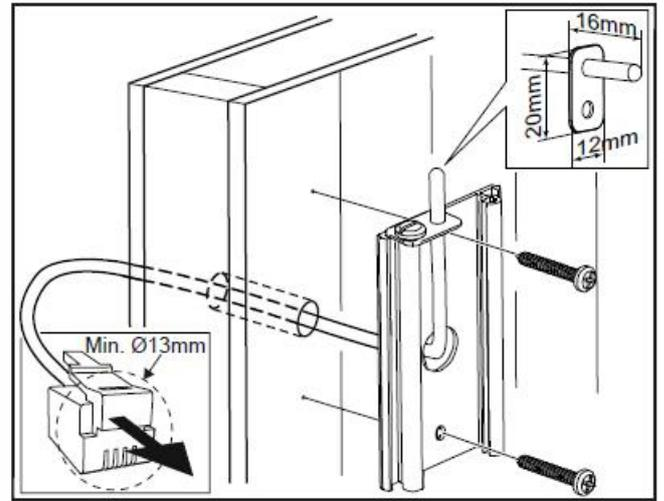
温度センサーの配線をサウナルーム壁の外側に設定される場合は上図のように設置してください。
