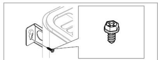
壁かけ用金具(ブラケット)とボルトが付属品で付いておりますので上図を参照し取り付けをお願いします。(ブラケット固定ビスの取付けも忘れずに(1箇所です))
