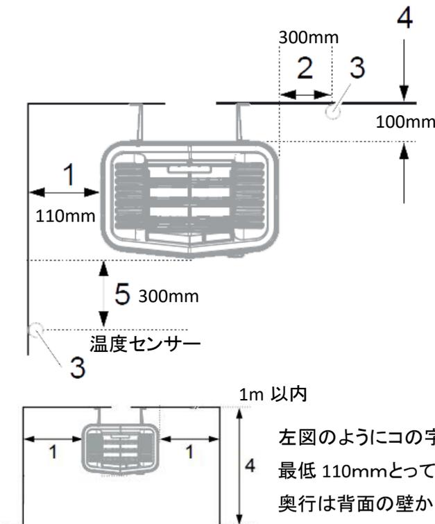
1. サウナ本体は左右側面、前方壁、ベンチから最低 110mm 離して設置してください。
