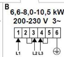
電源 200V 線は強固に結線してください。緩いと故障の原因になります。
